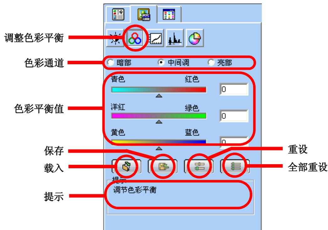
若要调整色彩平衡，请先选择要调整的通道，然后拖动三个色彩条下的三角形。您也可以在色彩条右侧的三个输入框中直接输入所需的数值，以调整色彩平衡。
